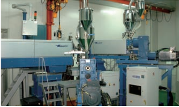
芬兰麦拉菲尔公司 500kV VCV 生产线
