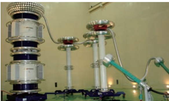
瑞士哈弗莱公司 700kV 局放耐压试验系统
