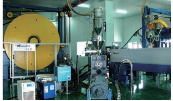
芬兰麦拉菲尔公司 220kV VCV 生产线
